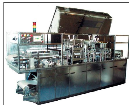
Рис. 5. Автоматическая линия фасовки и блистерной упаковки модели АЛБ 360
